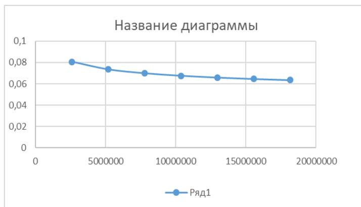
Рисунок 4.3.2. Изменение коэффициента теплопотерь в стволе скважины во времени:  $q=600 \text{ м}^3/\text{сут}$ ,  $H=2000 \text{ м}$ ,  $T_y=100^\circ\text{C}$
